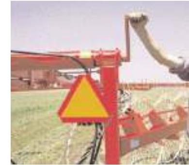
Dos registros de roscas sobre el bastidor principal, permiten variar en forma continua el ancho de la andana de acuerdo al volumen y estado del forraje.
