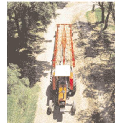
Para transporte se pliega hidráulicamente detrás del tractor y en línea con este, se bloquean los cilindros de las ruedas de barrido y se coloca una traba mecánica sobre las vigas.
