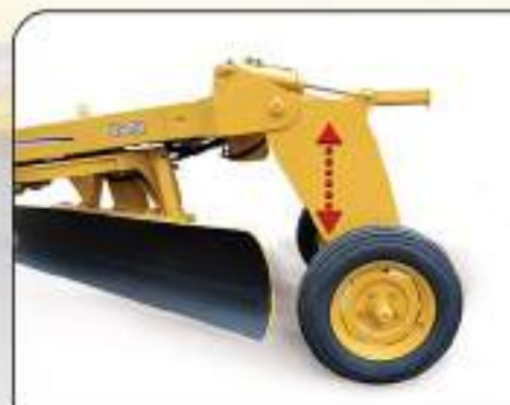
- Regulación hidráulica de profundidad de trabajo.
