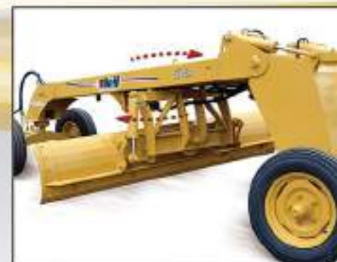
- Rotación hidráulica de vertedera.
