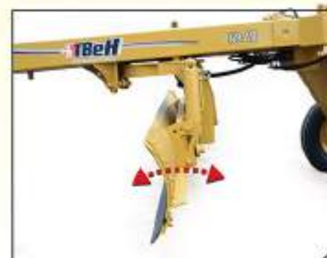
- Regulación manual de ataque de vertedera en 4 posiciones.
