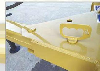
► **Lanza de tiro:** rebatible permite desplazar línea de corte fuera del ancho del tractor.
