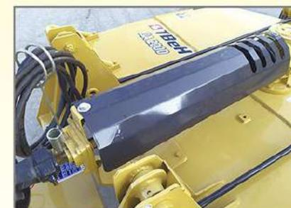
► **Transmisión:** Mediante barra cardánica con seguro a bolita y limitador de potencia.
